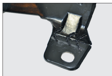
Волнистые скобы с крупной и мелкой змейкой 0.8 мм для ровных поверхностей, подверженных нагрузкам и вибрации.
