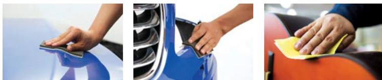
Применяется для шлифовки сложных контуров и углов.
