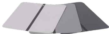
Металлическая загрунтованная пластина с полосой для тестирования автомобильных красок.
