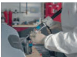
Материалы 3M™ Automix™ разработаны для быстрого ремонта трещин, сколов, вмятин и других повреждений на автомобильных деталях из любого вида пластика, а также восстановления недостающих пластиковых частей, например, креплений кронштейнов («ушек»). В результате нет необходимости заменять пластиковую деталь на новую.
