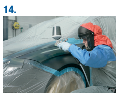
Нанесение базового покрытия
